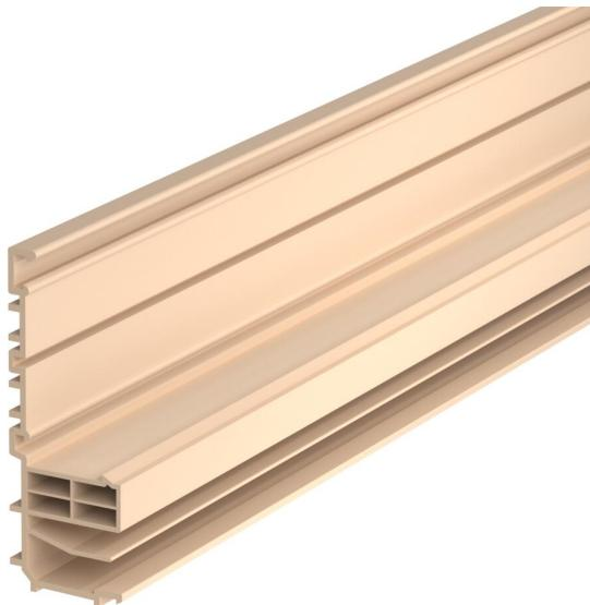
Base das calhas Rauduo com 2 canais individuais termicamente separados para a instalação conjunta de cabos elétricos e de aquecimento. Com função de encaixe para alojamento da tampa da calha. A cor da base da calha pode variar em função do fabrico.
