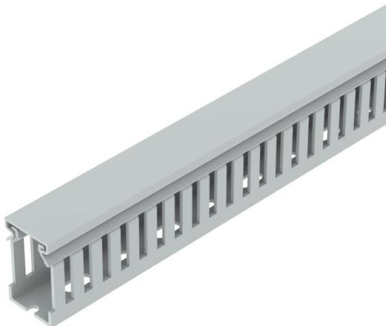
Calha de cablagem livre de halogéneos, inclui tampa e base perfurada para colocação horizontal e vertical de cabos e linhas elétricas no quadro de distribuição. Com fita adesiva de dupla face no fundo da calha como suporte de montagem. Versão métrica da calha. A quebra das barras pode ocorrer sem ferramentas. Comprimentos especiais disponíveis mediante pedido. Testado de acordo com a DIN EN 50085-2-3. Conjunto de base e tampa.
