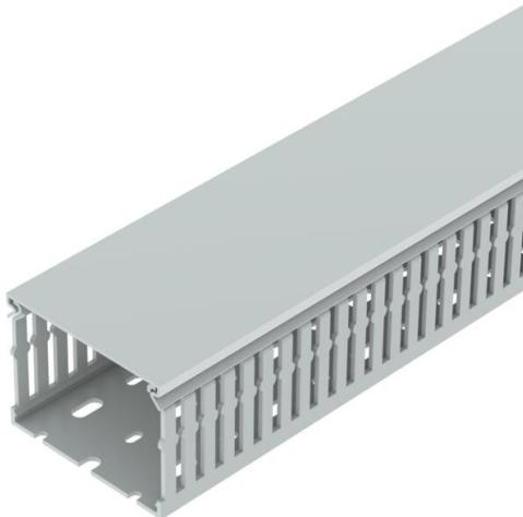
Calha de cablagem livre de halogéneos, inclui tampa e base perfurada para colocação horizontal e vertical de cabos e linhas elétricas no quadro de distribuição. Com fita adesiva de dupla face no fundo da calha como suporte de montagem. Versão métrica da calha. A quebra das barras pode ocorrer sem ferramentas. Comprimentos especiais disponíveis mediante pedido. Testado de acordo com a DIN EN 50085-2-3. Conjunto de base e tampa.
