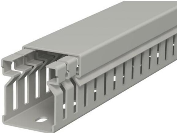
Calha de cablagem inclui tampa e base perfurada para colocação horizontal e vertical de cabos e linhas elétricas no quadro de distribuição. Versão métrica da calha. A medida nominal do tamanho do sistema corresponde à medida interna das calhas. A quebra das barras pode ocorrer sem ferramentas. A execução no pavimento é possível através de pontos de rutura nominais. Testado de acordo com a DIN EN 50085-2-3. Comprimentos especiais disponíveis mediante pedido.
