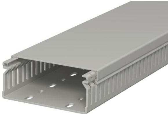
Calha de cablagem inclui tampa e base perfurada para colocação horizontal e vertical de cabos e linhas elétricas no quadro de distribuição. Versão métrica da calha. A medida nominal do tamanho do sistema corresponde à medida interna das calhas. A quebra das barras pode ocorrer sem ferramentas. A execução no pavimento é possível através de pontos de rutura nominais. Testado de acordo com a DIN EN 50085-2-3. Comprimentos especiais disponíveis mediante pedido.
