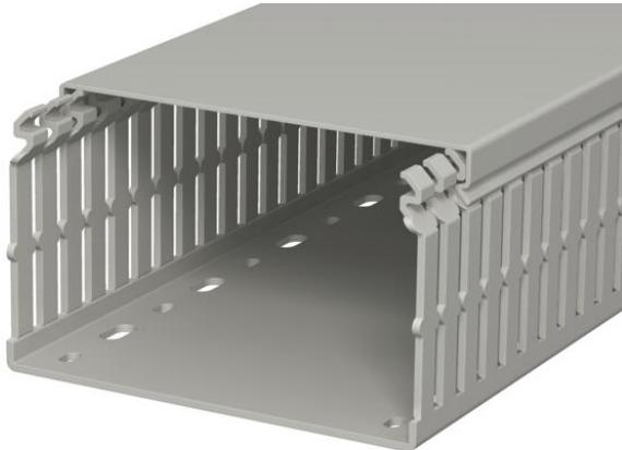
Calha de cablagem conforme a norma DIN EN 50085-2-3 inclui tampa e base perfurada para colocação horizontal e vertical de cabos e linhas elétricas no quadro de distribuição. Versão de calha DIN. A quebra das barras pode ocorrer sem ferramentas. A execução no pavimento é possível através de pontos de ruptura nominais. As ranhuras laterais impedem a queda dos cabos. Testado de acordo com a DIN EN 50085-2-3. Comprimentos especiais disponíveis mediante pedido.
