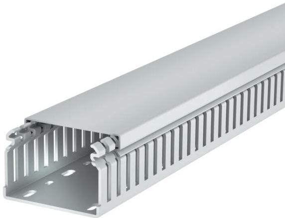
Calha de cablagem livre de halogéneos conforme a norma DIN EN 50085-2-3, inclui tampa e base perfurada para colocação horizontal e vertical de cabos e linhas elétricas no quadro de distribuição. Versão de calha DIN. A quebra das barras pode ocorrer sem ferramentas. A execução no pavimento é possível através de pontos de rutura nominais. Testado de acordo com a DIN EN 50085-2-3. Comprimentos especiais disponíveis mediante pedido.
