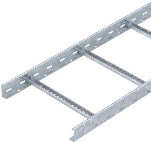
Caminho de cabos tipo escada com aba perfurada de 60 mm com degraus em perfil C, rebitados e abertos para cima (versão VS). O caminho de cabos tipo escada é fornecido fechado.
