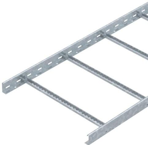
Caminho de cabos tipo escada com aba perfurada de 60 mm com degraus em perfil C, rebitados e abertos para cima (versão VS). O caminho de cabos tipo escada é fornecido fechado.
