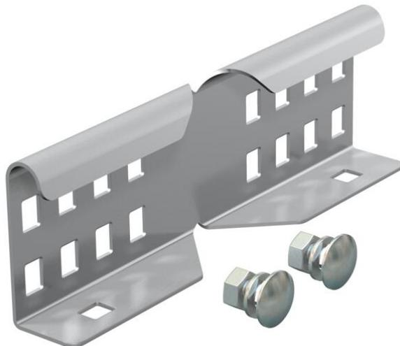
União curva como união exterior para a ligação de caminhos de cabos tipo escada e acessórios com uma altura de aba de 60 mm e perfuração contínua. A fixação por parafusos assegura a continuidade da ligação equipotencial.
