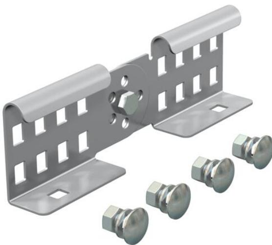
União articulada para a ligação de caminhos de cabos tipo escada com aba de 60 mm e perfuração contínua. Ângulo ajustável verticalmente.
