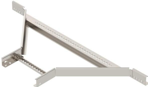
Peça de derivação com degraus soldados para montagem em caminhos de cabos tipo escada com altura lateral de 60 mm.
