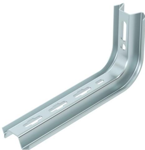
Perfil TP com comprimento de 145 - 645 mm, para utilização como perfil - cargas ligeiras em tectos de betão horizontais Até um comprimento de 345 mm, o perfil também é utilizado como consola para parede e para pendural. Se o perfil for fixado no tecto ou se for aparafusado para reforço superior, por motivos de estabilidade, deve ser sempre utilizado o acessório de aperto do tipo DS 4.
