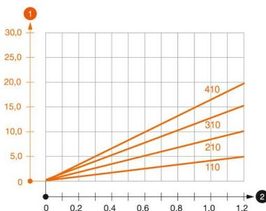
Diagrama de cargas da consola do tipo MWAM 12
