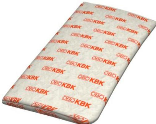
Almofada de proteção antifogo com fibra de vidro intrincada e isolante, de fixação mecânica, com enchimento especial. Sem fibras minerais, resistente ao clima e à prova de água. Aplicação em áreas interiores.
