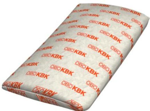
Almofada de proteção antifogo com fibra de vidro intrincada e isolante, de fixação mecânica, com enchimento especial. Sem fibras minerais, resistente ao clima e à prova de água. Aplicação em áreas interiores.
