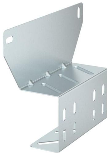
Suporte de montagem para fixação das caixas de derivação da série T-Box (com fixação exterior) em caminhos de cabos em chapa ou tipo escada com uma altura lateral de 60 mm. O formato dobrado da chapa de aço reforçada por meio de nervuras permite a montagem segura dos cabos de manutenção de funções, sem haver necessidade de dobrar o cabo sobre a travessa lateral.
