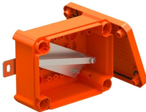
Caixa de ligação ou de derivação de cabos não equipada, fechada para montagem livre com bornes cerâmicos e buçins. A medida A indica o comprimento disponível da calha de suporte para os terminais da cablagem. Espaço da cablagem suficiente devido à calha suporte estar disposta na diagonal. Fixação a chapas exteriores, em aço inoxidável, facilmente acessíveis. Aprovado para instalações de cabos com manutenção de funções elétricas de acordo com a DIN 4102 parte 12 com as classes E30, E60 e E90.
