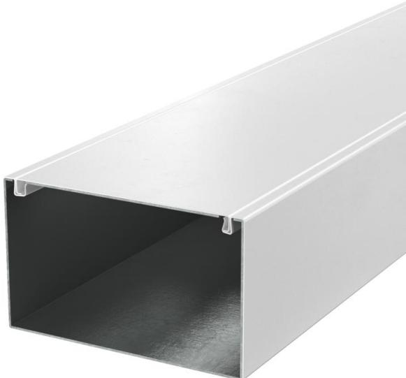
Ducto de instalação em metal com tecido intumescente de proteção contra incêndio para o encaminhamento de cabos à prova de fogo. Classificado como ducto de instalação EI30, EI60 e EI90 de acordo com a EN 13501-2, testado de acordo com a EN 1366-5. O ducto previne a propagação do fogo durante o período classificado e protege contra os efeitos de um incêndio nos cabos.
