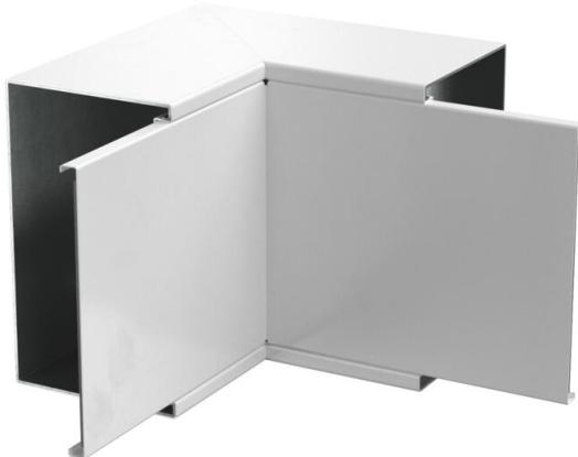
Ângulo interno com tecido intumescente de proteção contra incêndio para ducto de instalação PYROLINE® Rapid PLM. Adequado para a montagem direta na parede e no teto, montagem abaixo de sistemas de chão e em sistemas de suporte. Montagem de juntas, sem ferramentas, com união PLM SI. A tampa é encaixada, sem ferramentas, e permite uma rápida revisão e uso posterior. A projeção da tampa permite a instalação desfasada da tampa para a ligação equipotencial contínua de toda a secção do ducto.
