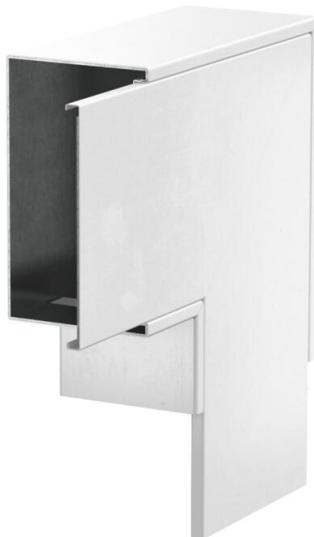
Ângulo plano com tecido intumescente de proteção contra incêndio para ducto de instalação PYROLINE® Rapid PLM. Adequado para a montagem direta na parede e no teto, montagem abaixo de sistemas de chão e em sistemas de suporte. Montagem de juntas, sem ferramentas, com união PLM SI. A tampa é encaixada, sem ferramentas, e permite uma rápida revisão e uso posterior. A projeção da tampa permite a instalação desfasada da tampa para a ligação equipotencial contínua de toda a secção do ducto.
