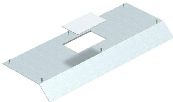
Tampa do adaptador para aparelhos para base da calha AIK/U para a montagem de um adaptador para aparelhos do tamanho 2. Abertura de montagem fechada com espelho cego de alumínio de 2 mm. A tampa da calha é aparafusada nos perfis laterais Al da base da calha. A inclinação da tampa fica saliente na base da calha num ângulo de 45°.
