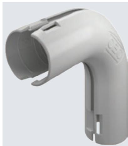
Acessório para tubos de instalação elétrica em plástico para a criação de ângulos de 90°. Adequado para tubo Quick-Pipe® ou tubos corrugados. Fecho e abertura sem ferramentas. Utilizável com uma amplitude de temperaturas de -25° a + 60 °C.
