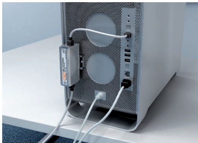
Proposta de proteção no aparelho terminal. De forma a manter o nível de proteção baixo, o aparelho de proteção contra sobretensões utiliza o condutor de proteção da caixa do computador como ligação PE
