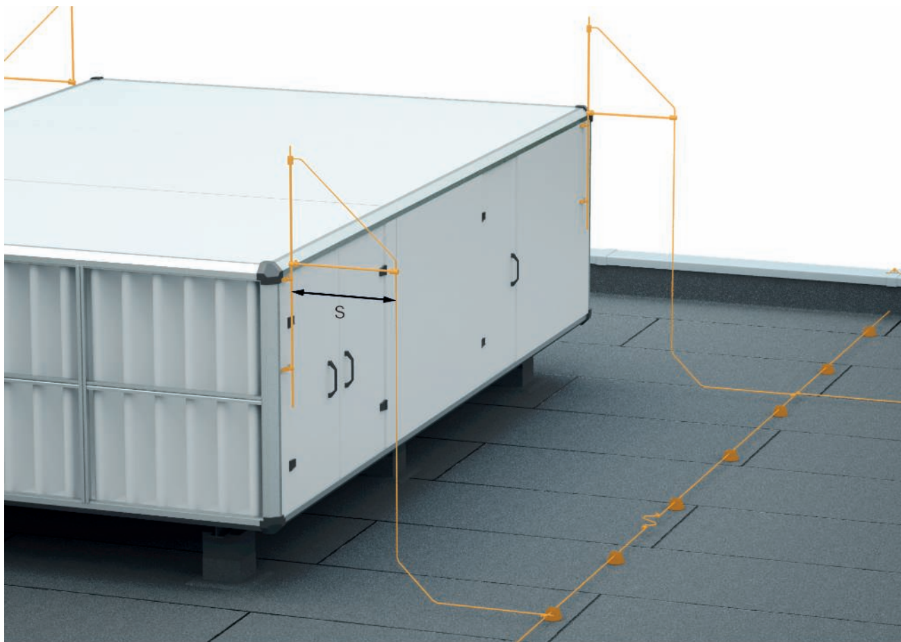
Distância de separação (s) corretamente mantida entre os dispositivos condutores de descida e as estruturas do telhado
