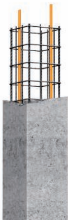
Exemplo: Uso de colunas de betão armado/instalação de baixada
