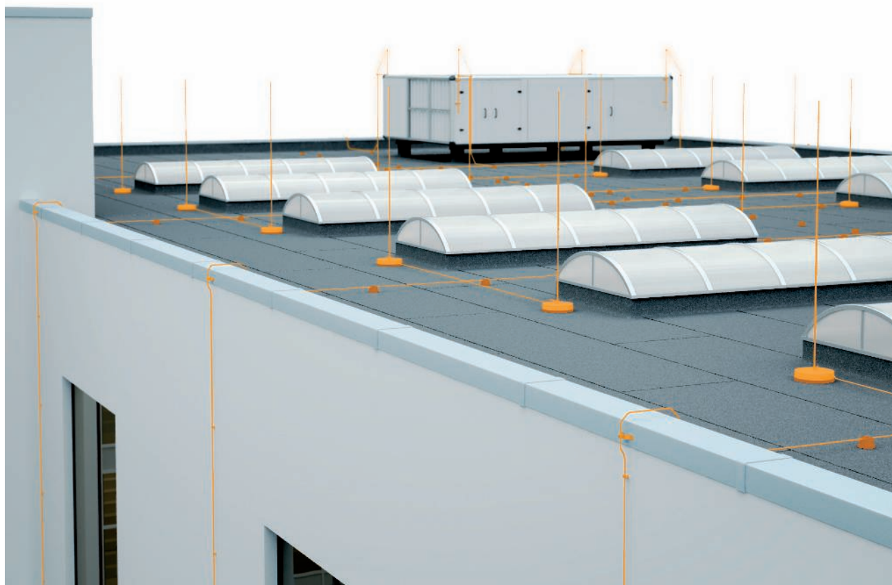
Componentes naturais (aqui chapa metálica) para sistemas de captação, VDE 0185-305-3 (IEC 62305-3)
