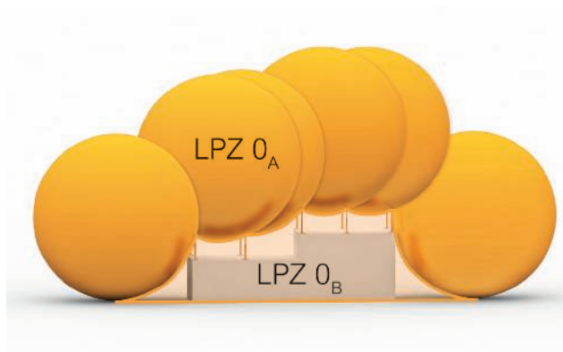
Método de esfera fictícia e zonas de proteção contra raios (LPZ) resultantes
