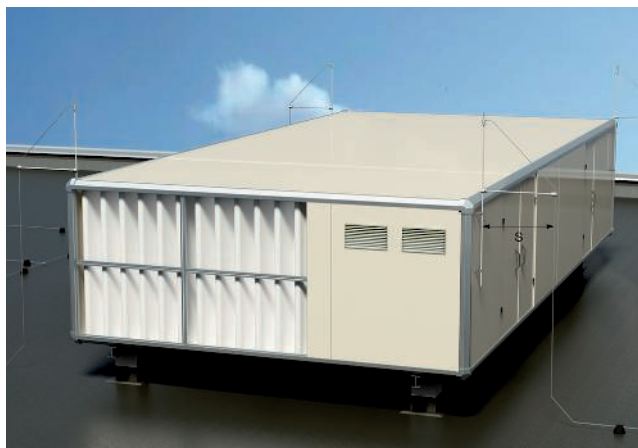
Sistema captor isolado com distância de separação (s)
