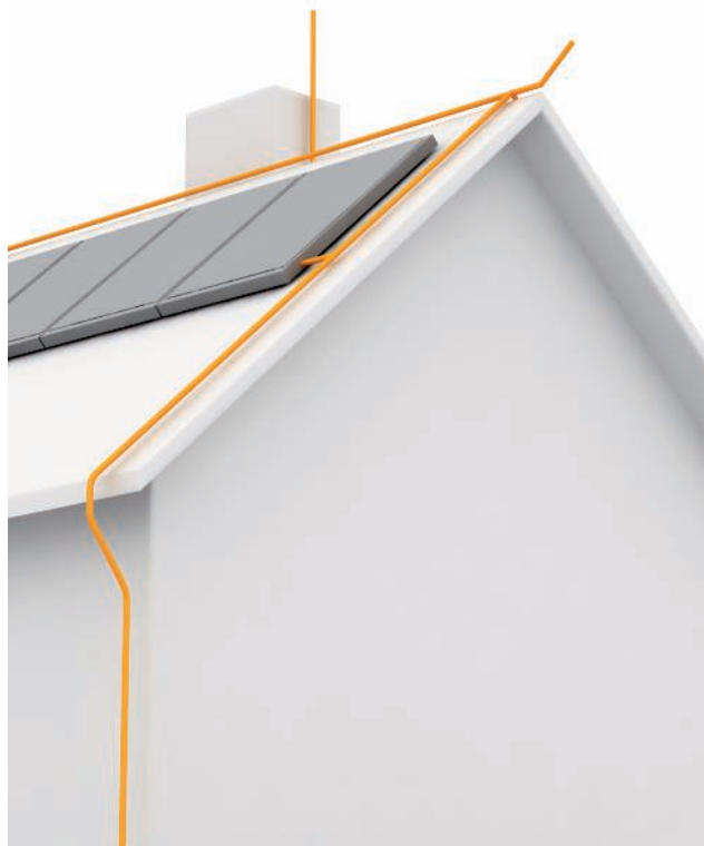
Ligação direta das estruturas de montagem fotovoltaicas ao cabo de proteção contra raios
