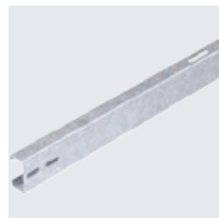
Perfil de estrutura para montagem de módulos fotovoltaicos em sistemas em espaço aberto. Montagem do perfil de estrutura em estruturas pré-montadas com cruzetas KV FT. Montagem dos módulos fotovoltaicos no perfil de estrutura com terminais finais e/ou inter-médios. Ligação de vários perfis de estrutura com união reta LV FT ou cruzeta KV FT, aparafusável.
